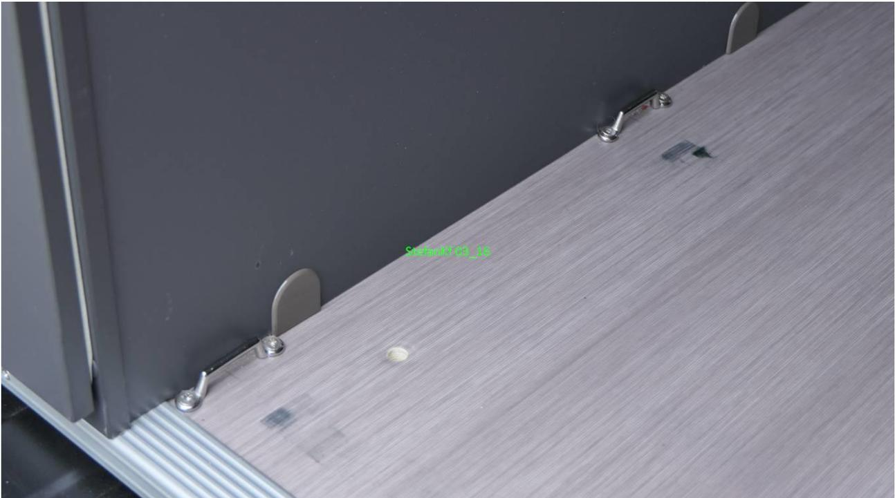
Befestigung Staukisten 4 (Gurthaken oben, durch Gasflaschenkasten)
