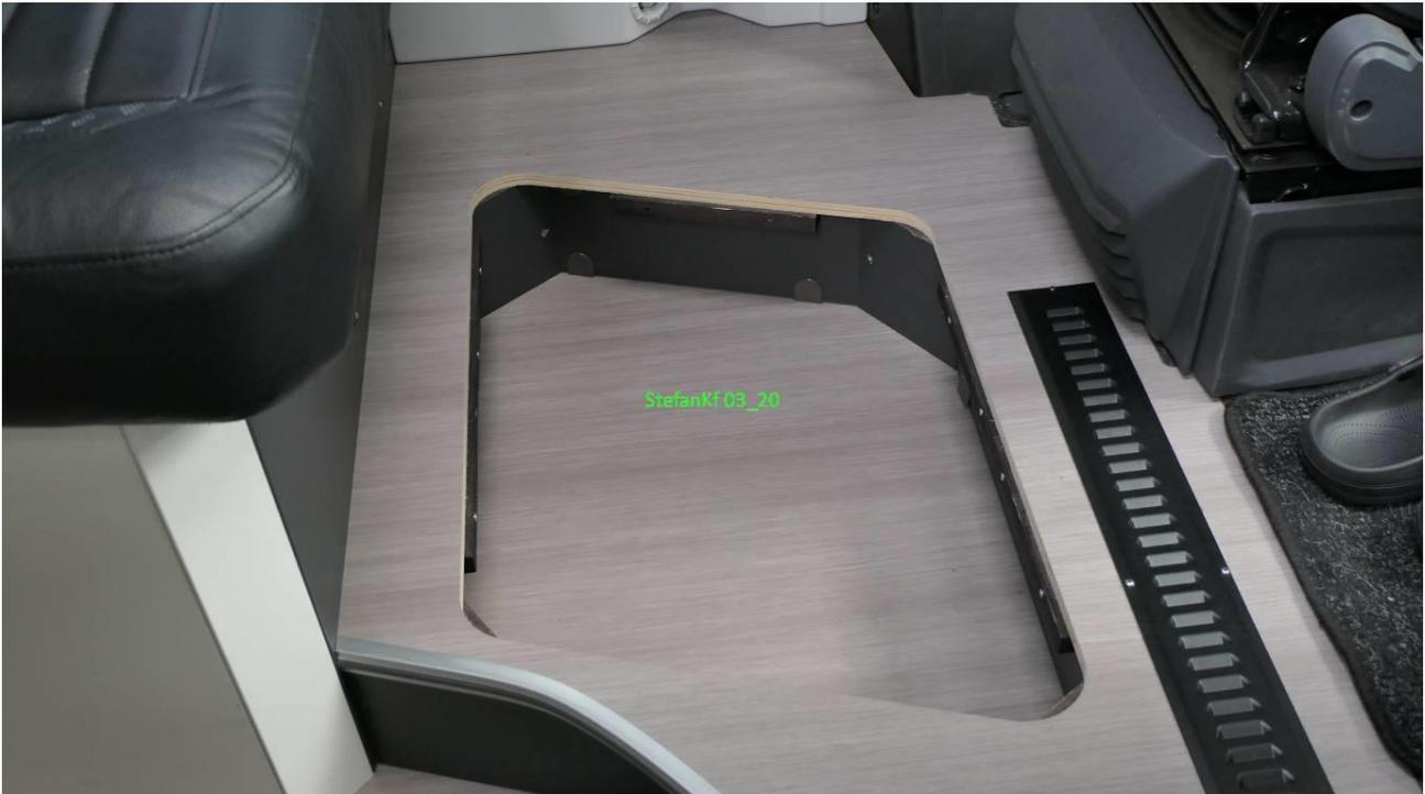
Zugang Stauraum Dinette (Sicherung hochgeklappter Tisch per Seil oder per Gurt für einfachen Zugang)
