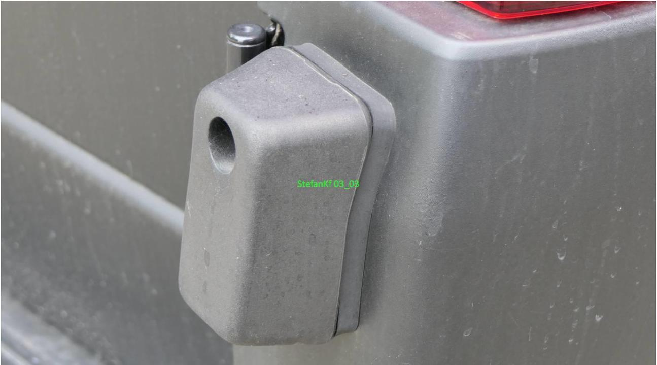
Anschlag Hecktür 2 (Scheibe in Hecktür schlägt nicht mehr Fahrzeugkarosserie an)
