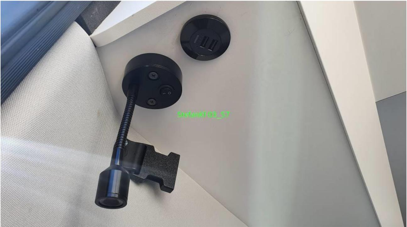
Beleuchtung + USB-Doppelanschluss am Kopfende (Beifahrerseite)
