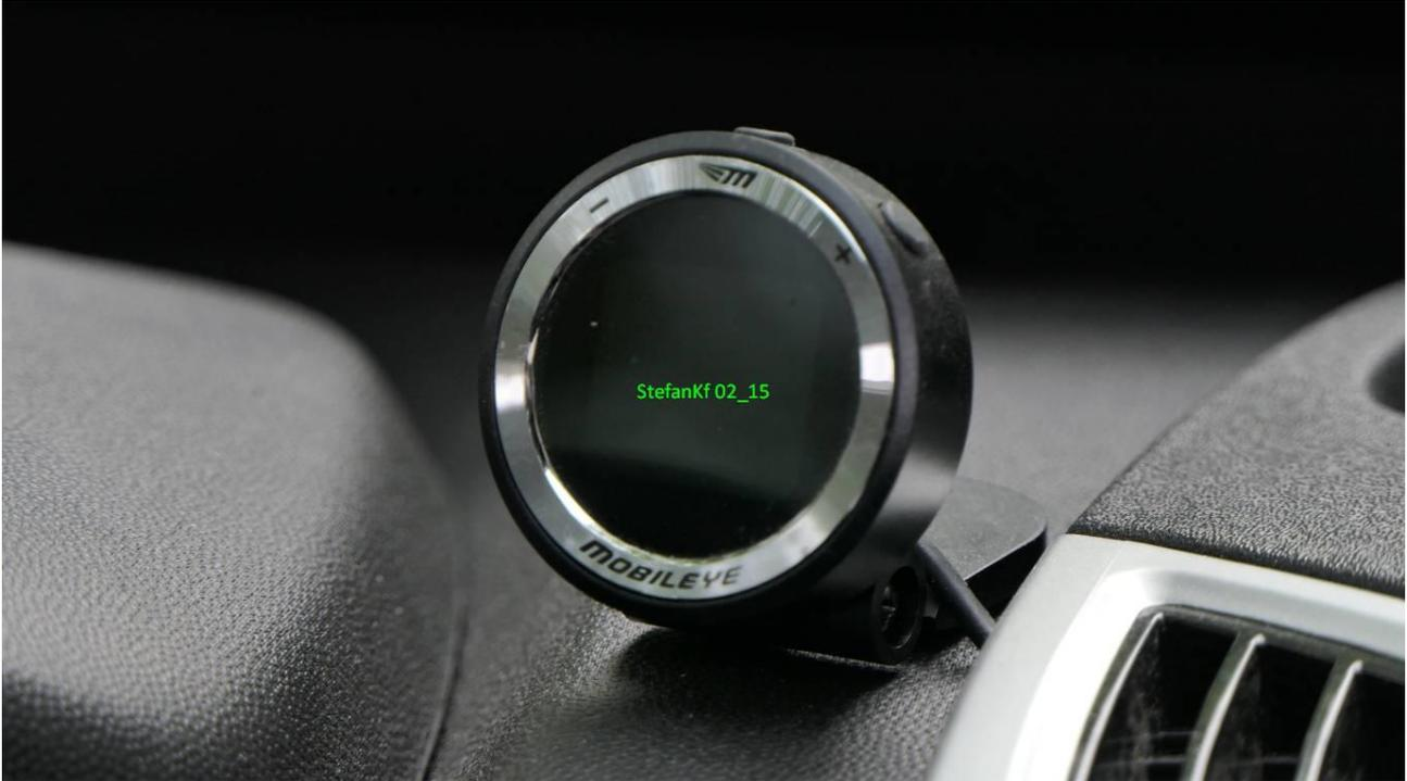
Mobileye-Kamera + GPS-Sensor für Navi
