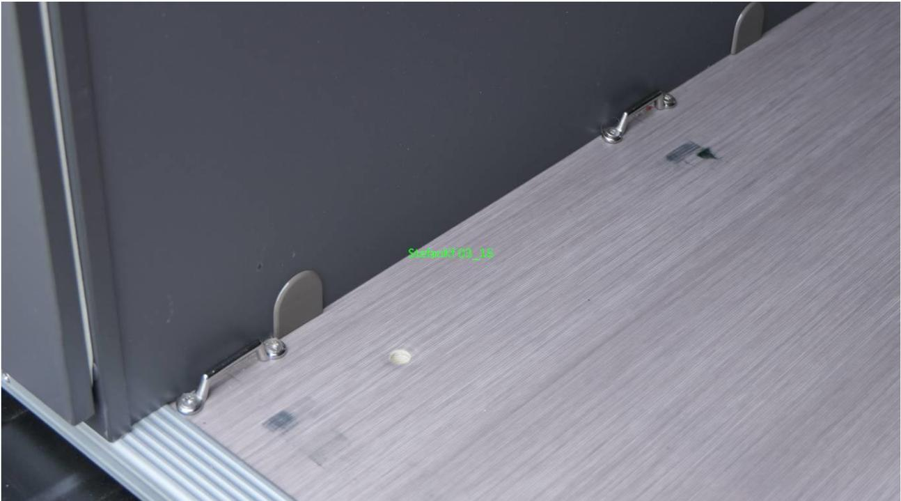
Befestigung Staukisten 4 (Gurthaken oben, durch Gasflaschenkasten)
